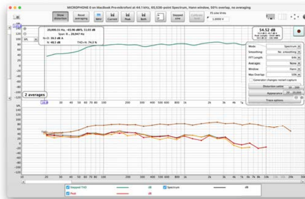
Kuva 17: Measurement using REW’s Real-Time Analyzer (RTA)
